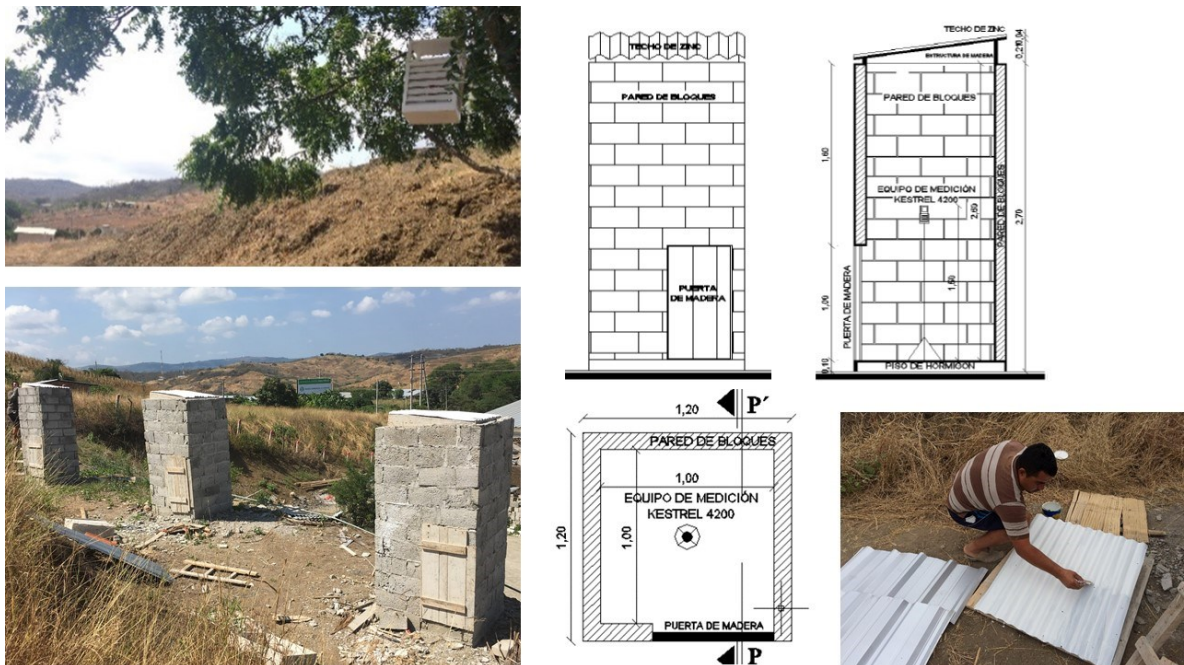
Figura 33. Elevación y corte del módulo experimental, equipos de medición y cabina bajo el árbol para medición en exterior de referencia. (Elaboración propia)
