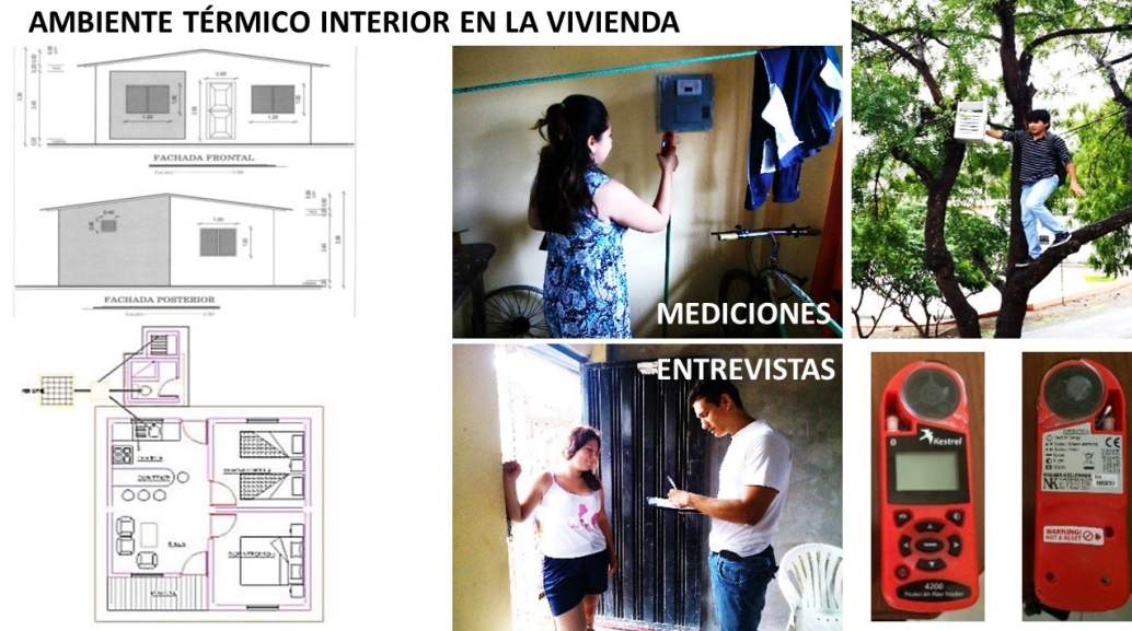
Figura 18: Equipo de medición ubicado en el interior y exterior de la vivienda. (Elaboración propia)
