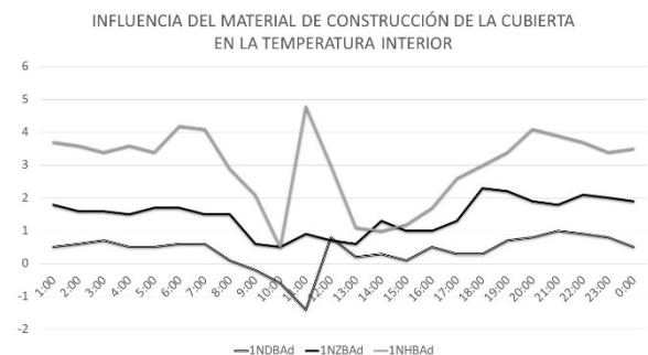
Figura 25: Temperatura del aire interior en viviendas adosadas de una planta orientadas al norte, con paredes de bloque y diferentes materiales de cubierta. (Elaboración propia).
